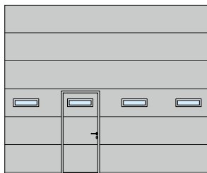
SPU F42, SPU 67 Thermo Lamelové okná typ D umiestnenie integrovaných dverí vľavo
